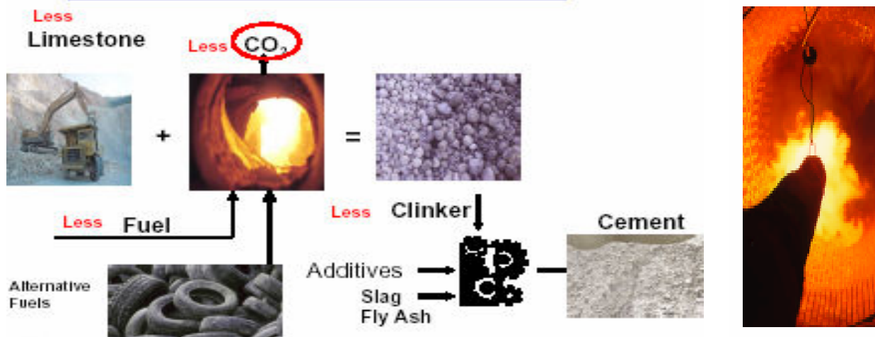
شکل ۲ - احتراق در کوره‌ها، مهمترین مکان تولید دی اکسید کربن در فرآیند تولید سیمان
